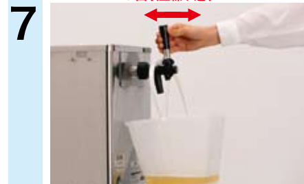
7 ビールが水に変わったらカランレバーを押して「泡付け」の位置にし、泡付け通路を洗浄する。再びカランレバーを手前に引いて、ビール回路に水を流す。(この操作を5回以上繰り返す。カラン根元のナットのゆるみに注意)
