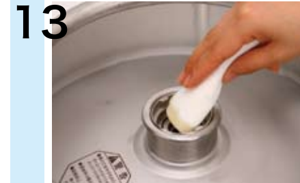
13 ビール樽の口金に残っているビールをキッチンペーパーで拭き取る。
