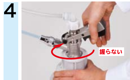
4 水を入れた洗浄ボトルにヘッドを取り付ける (熱湯や薬剤等は絶対に入れない)
