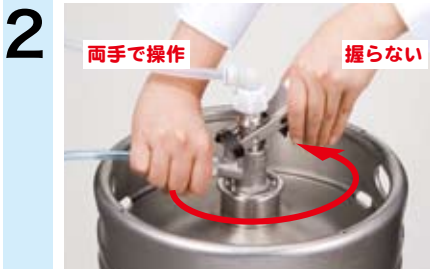
2 両手で操作 握らない 開閉ハンドルを閉じて、ヘッドを樽から外す。
