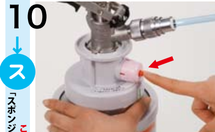
10 ガス抜きボタンを押す(必ず実施) 洗浄ボトルのガス抜きボタンを押し、残ガスがないことを確認。
